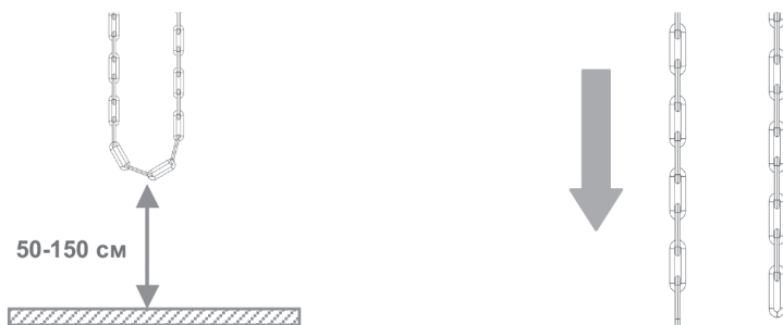
Рис. 2. Управление воротами с использованием ручного цепного редуктора
